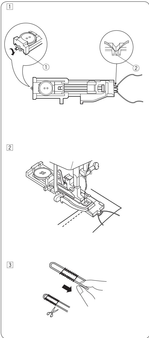
**[1]** Nechajte pätku pre gombíkové dierky s posuvným pravítkom hore a zaháknite výplňovú šnúrku za ostrohu vzadu na pätku pre gombíkové dierky s posuvným pravítkom.
